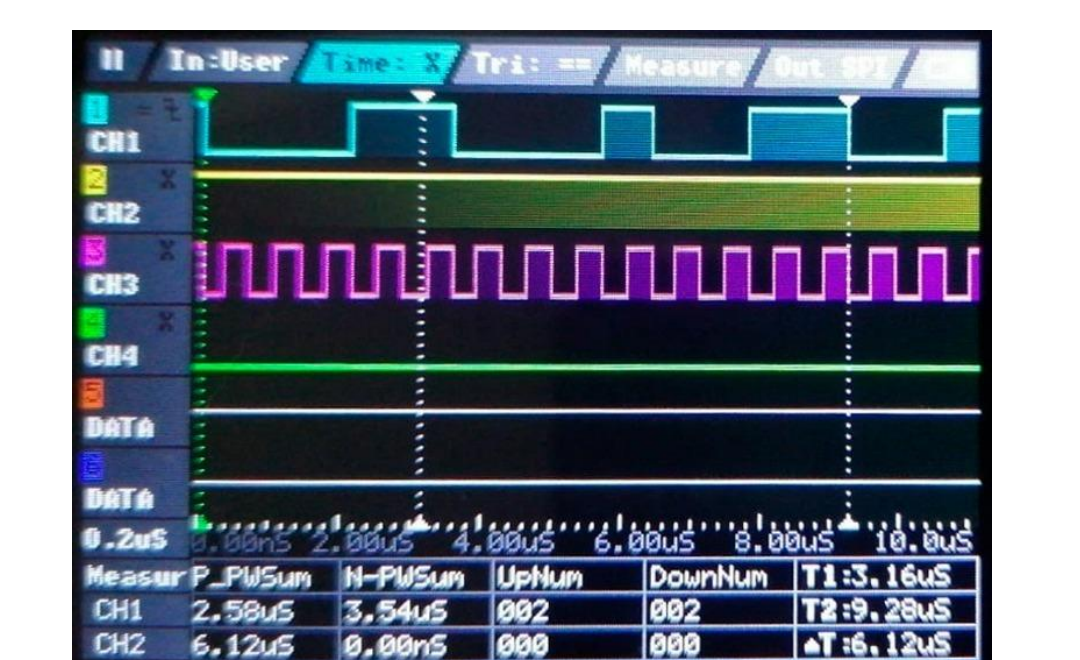
Fig. 9. Salida del ESP32 en los pines de SPI
